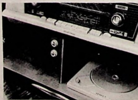
Bild 2. Einbau des Stereo-Zusatzverstärkers bei den „stereo-sicheren“ Schaub-Lorenz-Musiktruhen
