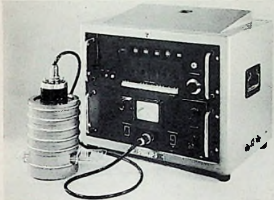
Bild 2. Strahlungsmeßplatz für Einzelzählungen, bestehend aus fünf Zählrohren mit Röhren E 1 T, Vorverstärker und Stromversorgungsteil. Links eine Bleikammer zum Untersuchen radioaktiver Präparate und von oben eingesteckter Geiger-Müller-Sonde
