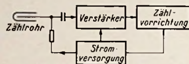
Bild 7. Prinzip eines Strahlungs-Meßgerätes
